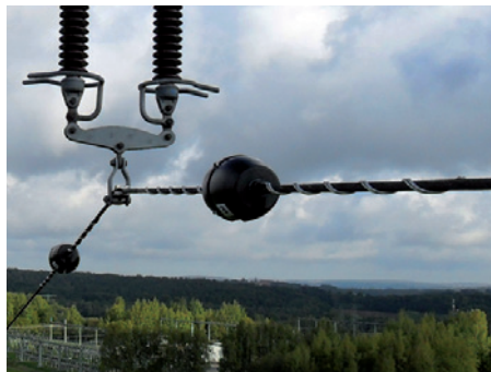
Neigung, Verdrillung und Temperatur der Hochspannungsleitung (Die Daten zu Verdrillung und Neigung infolge Durchhang sind um einen definierten Offset verschoben.)
