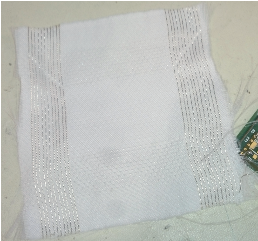
Abbildung 3: Prototyp einer gewebten, textilen Spule zur induktiven Energieübertragung. Foto © Fraunhofer ENAS, TITV Greiz
