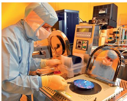
*Spitzenforschung in Sachsen: Gunther Schwenzer arbeitet im neuen Reinraum des Zentrums für Mikrotechnologien der TU Chemnitz an einer Anlage zur Waferbelackung.*
