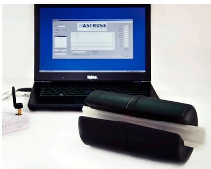
*Im Projekt ASTROSE wurde von Fraunhofer gemeinsam mit Forschungs- und Industriepartnern ein Sensornetzwerk zur Überwachung der Auslastung von Hochspannungsnetzen entwickelt. Der Sensorknoten wird direkt an die Stromleitung angebracht und sendet Daten zu Temperatur, Stromfluss und Neigung des Leiterseils zum nächstgelegenen Sensorknoten.*
