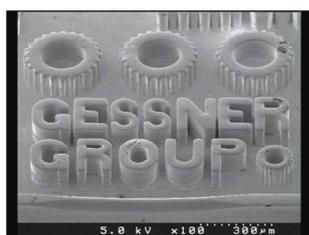
Mikro-Abformung von Metallschem Glass (Quelle: WPI-AIMR)
