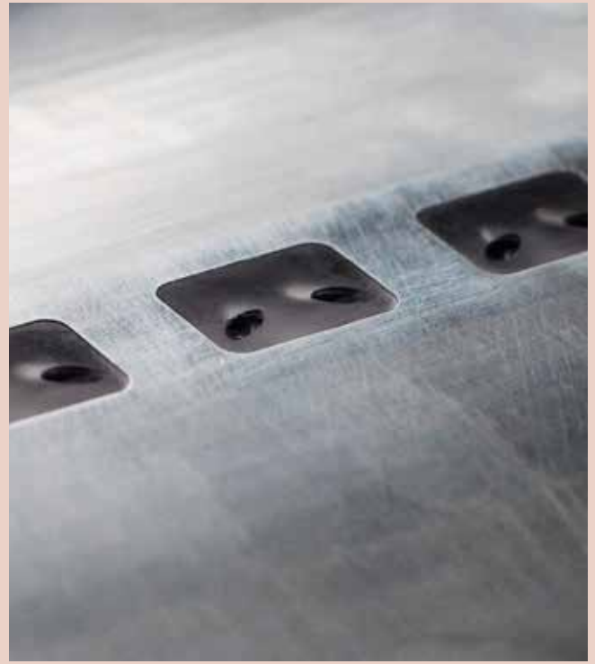
Austrittsdüsen der integrierten fluidischen Aktoren in einem 2.5-D-Modell eines Rotorblattes. (Foto © 2021 Fraunhofer ENAS)
