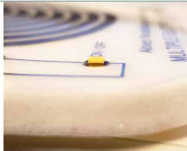
Technologiedemonstrator für ein elektrisch aktives Wundpflaster mit gedruckten Elektroden auf flexiblen Substraten.
