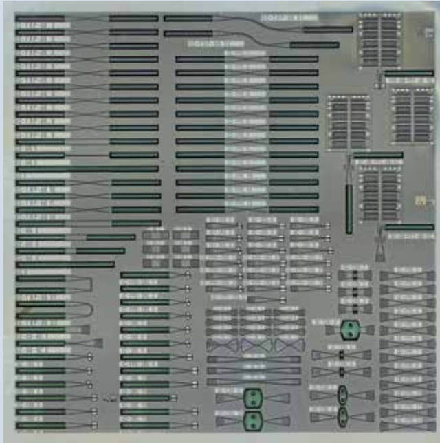
Spektrometer-Komponenten auf SOI-Wafer (Infrarotquellen, Wellenleiter, Filter und Koppler).
