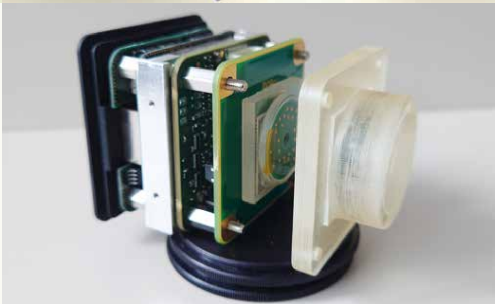
Hyperspektrales Kamerasystem mit Vision-System-on-Chip-(VSoC)-Bildsensor und einem am Fraunhofer ENAS entwickelten abstimmbaren Fabry-Pérot-Filter. (Foto © Fraunhofer IIS/EAS)
