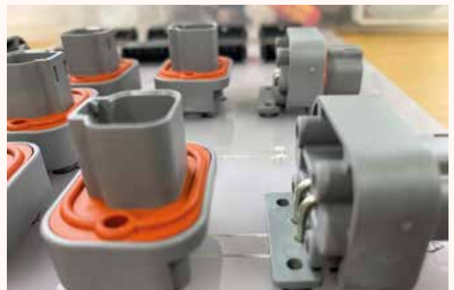
Gedruckte Leiterbahnen elektrisch und mechanisch kontaktiert an für KfZ zugelassenen Steckverbindern.
