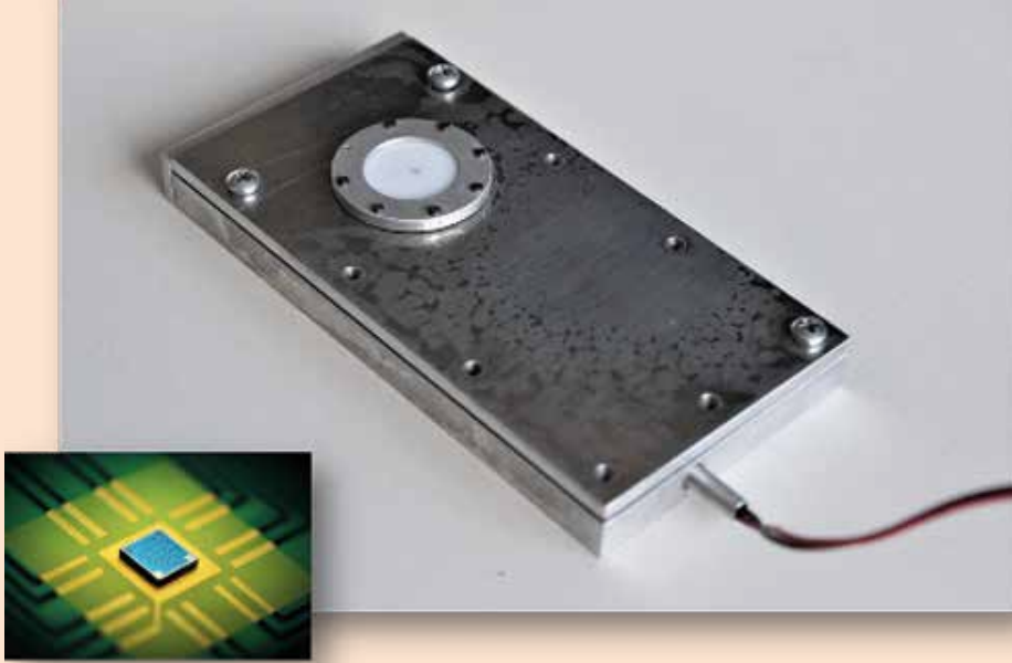
Der Wandler, montiert auf einer Leiterplatte, und das Gehäuse.
