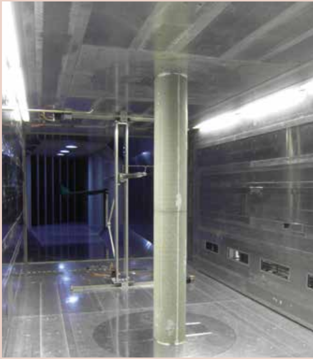
Windkanalmodell bestückt mit Aktorik im DNW in Braunschweig. (Foto © 2021 Niko Bier, DLR)
