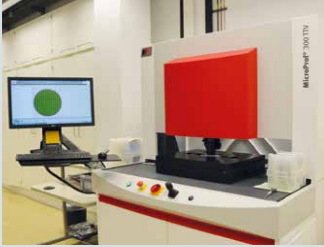
Geometrie- und Schichtdickenmessgerät »FRT MicroProf300TTV«.
