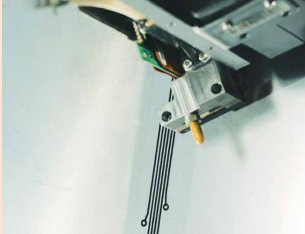
Herstellung eines Kabelbaumsegmentes auf die Innenseite einer Fahrzeugtür mittels Sechsa-Achs-robotergestützter Inkjet-Drucktechnologie.
